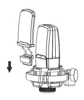
提示:也可以卸下防喷网,更换成防风棉,两者只选用一款即可。防喷网造型美观,对声音的保真度保持较好,但防口水作用略低于防风棉。防风棉在防口水方面表现更佳,但易遮挡麦克风头部影响整体美感,且通透性没有防喷网好,对麦克风音质还原有轻微的影响。具体可根据个人的喜好选择使用。
