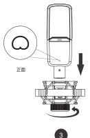
3. 将附带的防喷网安装至防震架上, 如图所示:
